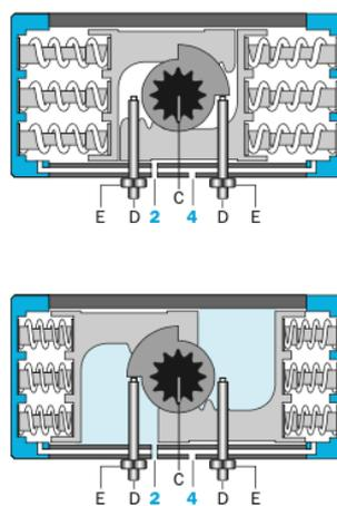
Dans la version à simple effet, les ressorts ramènent les pistons dans leur position initiale lorsque l'orifice "2" est purgé. Le nombre de ressorts est adapté à la pression de commande existante.
