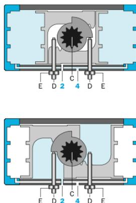
Lorsque les deux chambres extérieures sont mises sous pression via le raccord "4", les pistons se déplacent l'un par rapport à l'autre jusqu'à la position initiale (0°). La force des deux pistons est transmise au pignon "C" par les crémaillères. Si l'orifice "2" est mis sous pression et que "4" est purgé, les pistons s'écartent dans la position 90°.
